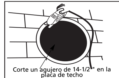
Figure 6 – Corte el orificio de entrada de aire
